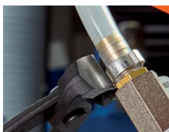
10 98 I220: Utěsnění připojení hadice na centrálním mazání
