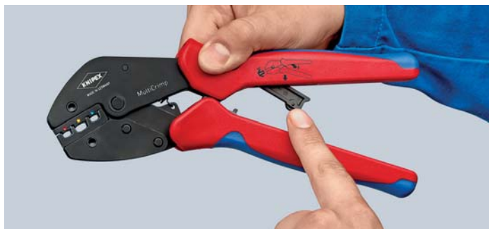
Sklopte servisní páku a promáčkněte kleště – jsou připraveny pro příští použití
