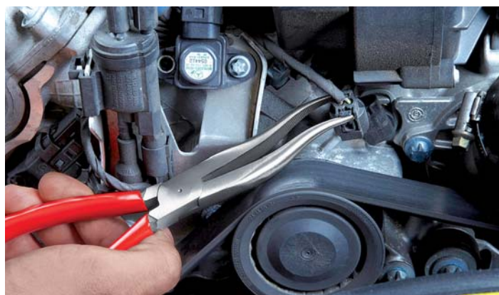
Jemné uvolnění hadice v uzavřených prostorech
